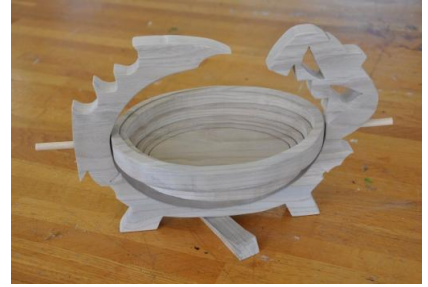
6mmの棒を差し込み片側接着。
