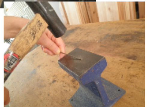
《ピアノ線をレール床の上で叩く》
